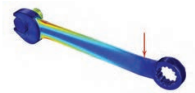
شکل ۵-۱۲- قسمت های بحرانی یک آچار هنگام بارگذاری
